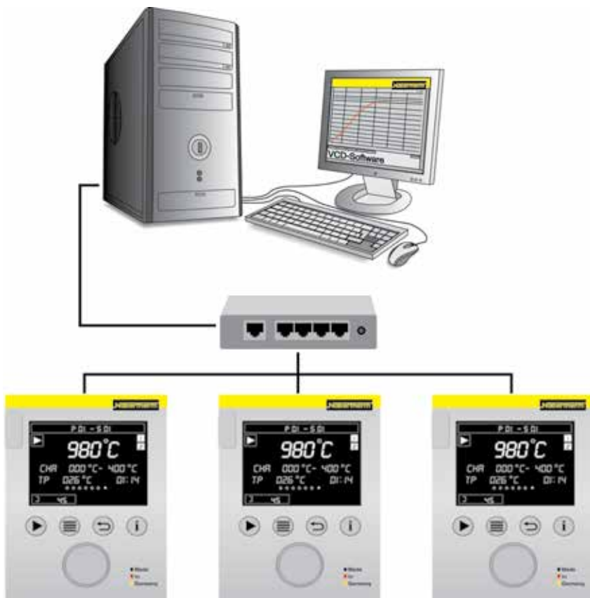
Пример конструкции с тремя печами
