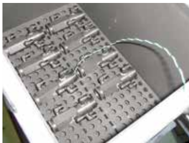
Frittage d'éléments en titane MIM dans four VHT
