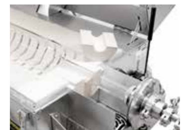
Pièces d'adaptation pour le fonctionnement avec tube de travail ou réacteur de process en alternance
