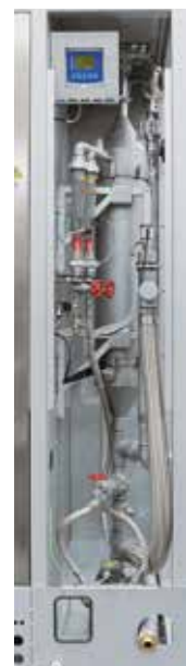
Système de lavage pour la purification des gaz d'échappement du processus par lavage
