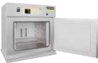
Étuve TR 240 pour le séchage des poudres
