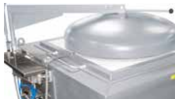
Régulateur du bain de fusion avec thermocouple dans la masse fondue
