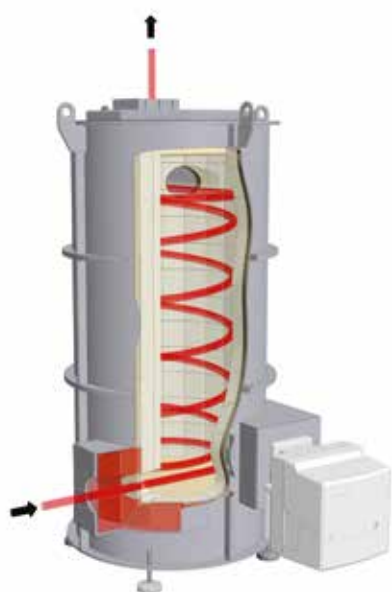
Représentation Schématique d'une postcombustion thermique (TNV)
