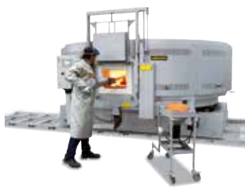
DH 2500/S sur rails permettant un déplacement entre deux forgeages
